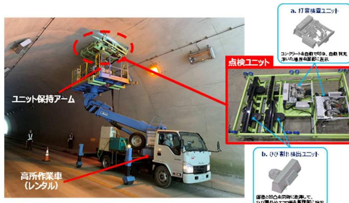
図4.2.3 システムの概要図
